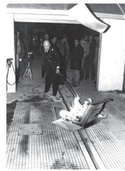
Essai de résistance au feu d'un siège du métro, après aspersion d'essence, AMVA, EPALE, 9Fi943
