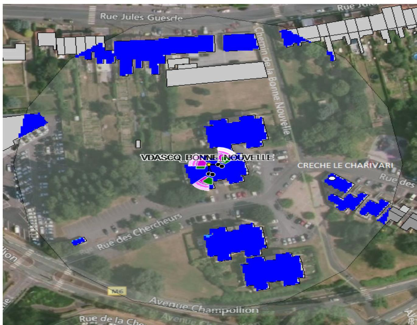
Carte de simulation antenne à faisceau orientable S1 à 3m de Hauteur
